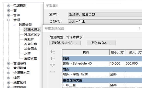
图 4 Revit 水管配置
