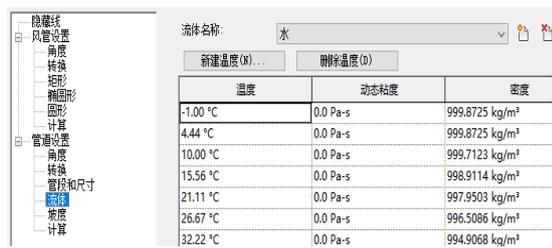
图 5 Revit 水管内介质设定
