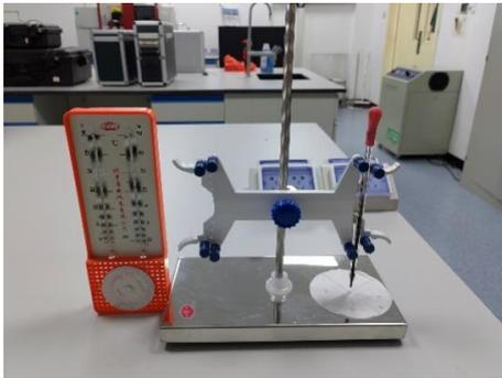
图4 水平湿扩散速率实验装置
