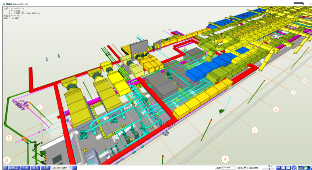
图6 福州路站管线综合初始模型
