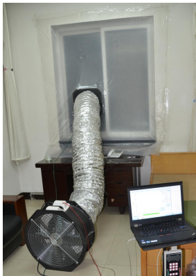
图 1 外窗气密性现场实测图
