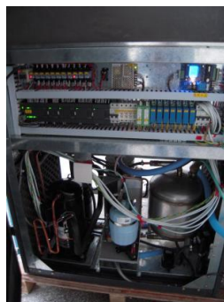
图 10 带冷凝水回收的自循环装置图
