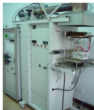
图 5 锥形量热仪结构及外形
