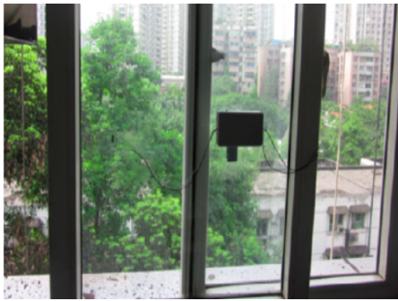
图1 窗口状态位移记录装置
