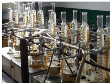
图 2 腐蚀性测定装置
