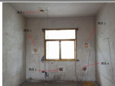
图 5 建筑内部测点布置
