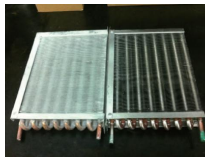
图 6 除湿换热器（左）和显热换热器（右）
