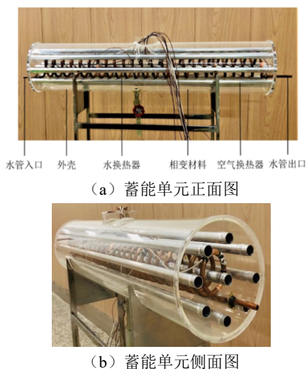
图 2 相变蓄能单元的原型
