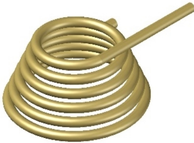
图 2 所设计冷凝器结构示意图
