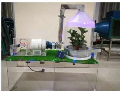
图 10 绿植协同光催化净化空调系统实物模型图
