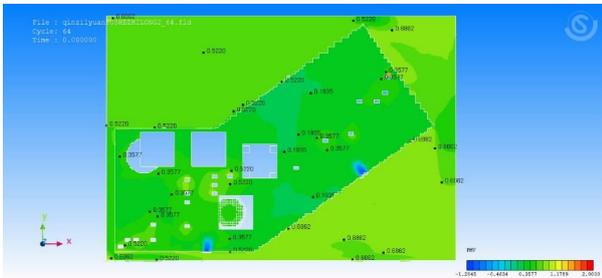
图 18 Z=700mm 截面辐射供冷加新风方式 PMV 分布云图
