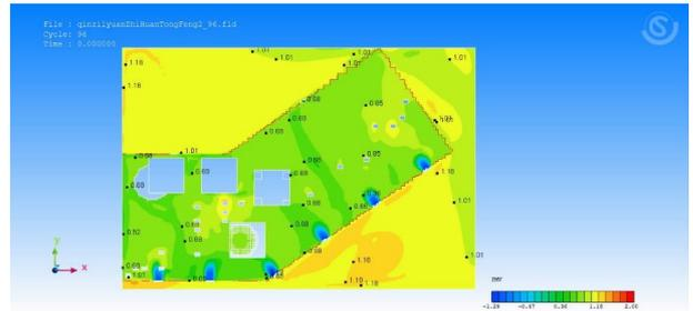
图 21 Z=700mm 截面置换通风方式 PMV 分布云图
