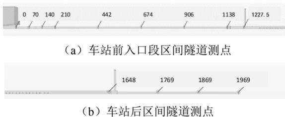
图 5 隧道压力测点示意图
