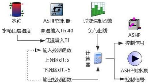
图 3 ASHP 控制连接图
