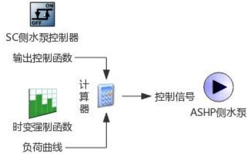
图 4 串联式 HSSAASHP 的 ASHP 侧水泵控制连接图
