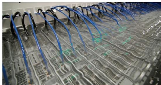
图 1 浸没式液冷数据通信设备
