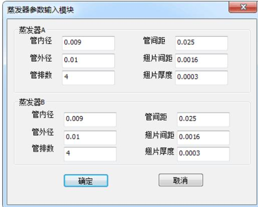
图 6 蒸发器结构参数输入模块
