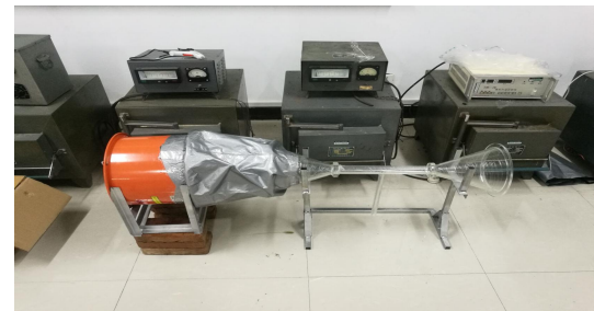
图 3 蒸发冷却空调装置实验台
