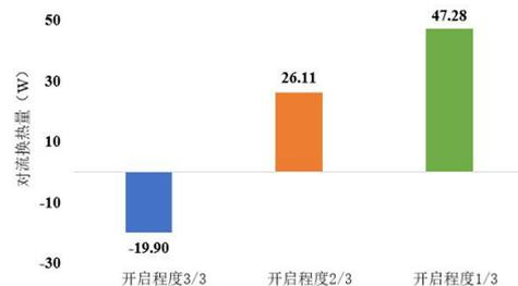
图 9 遮阳工况时百叶帘开启程度对外窗内壁对流换热的影响
