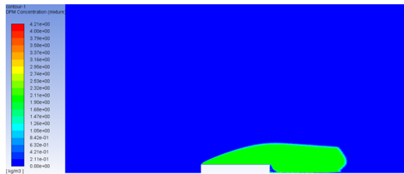
图 6 (b) 风速为 3m/s 时粉尘扩散模型
