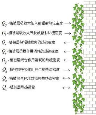
图 1 绿植围护结构能量收支图
