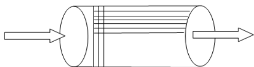
图8 制冷剂通过过热平衡器的示意图
