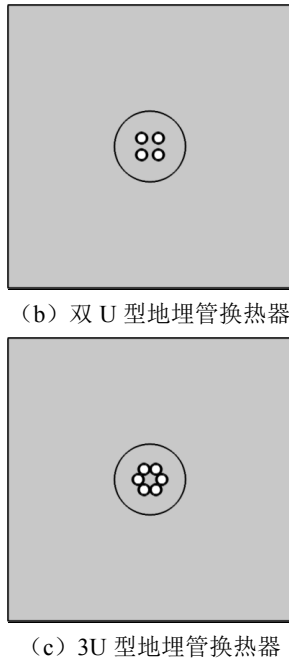
图 1 不同类型的埋地管换热器的几何模型
