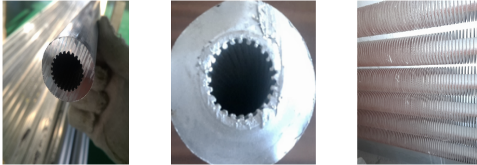
图 6 热管局部结构图
