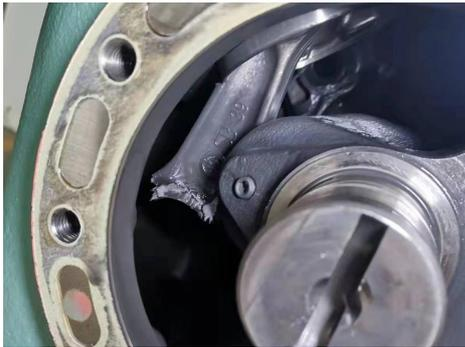
图 2 压缩机连杆断裂图
