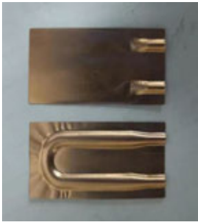
图 3 冷凝器底板与盖板实物图
