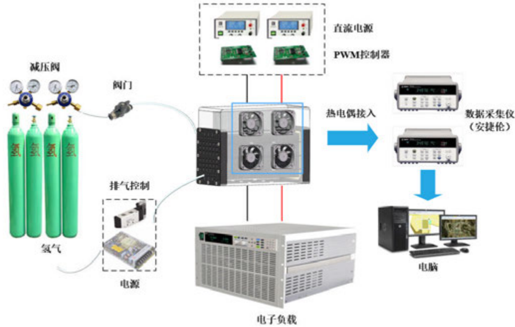
图2 MHPA-PEMFC 电堆性能测试实验系统图 Fig.2 Experimental system
