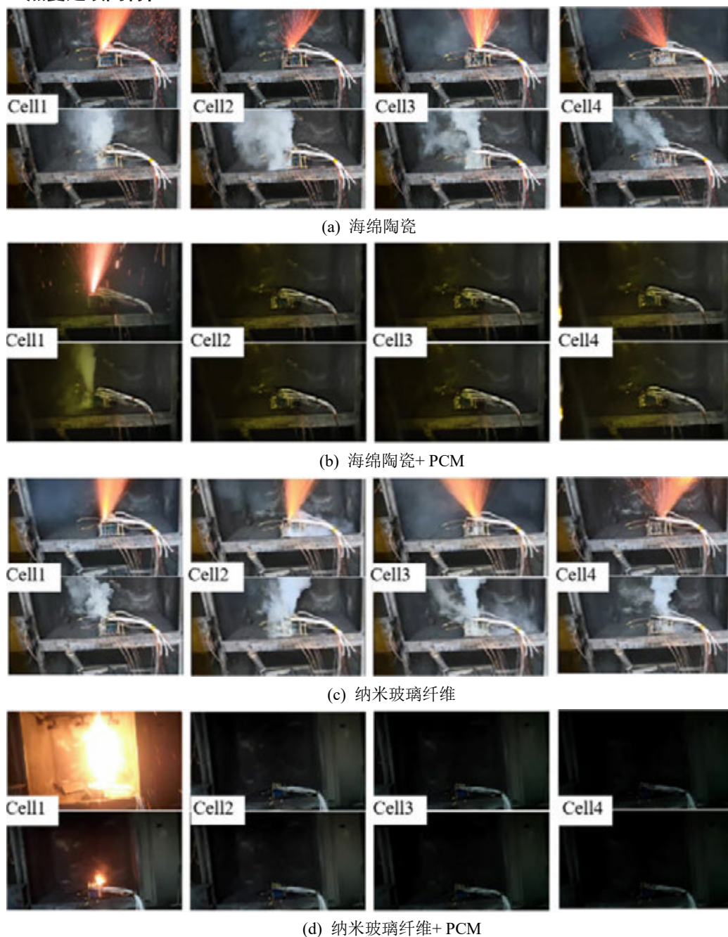
图 2.5 不同隔热层模组的热蔓延喷阀特征
