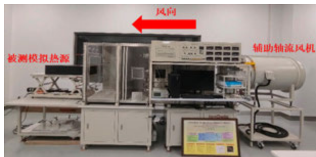
图10 全自动风量及压力测量仪
