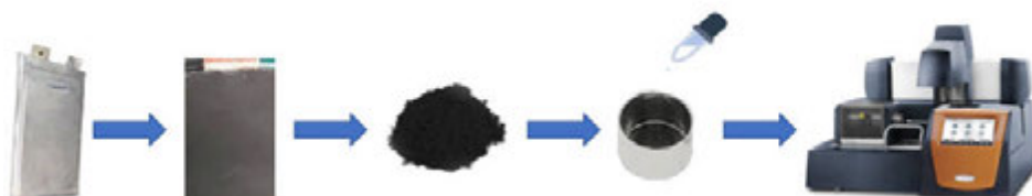
图 3 DSC-TG-MS 制样流程
