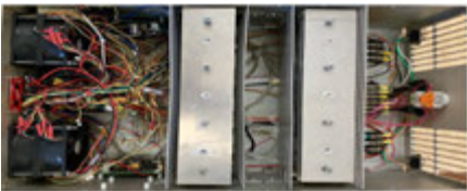
图 2 服务器模拟器内部结构
