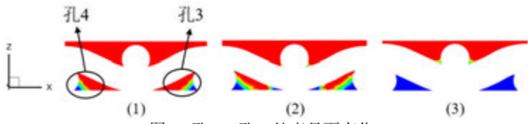
图 9 孔 4、孔 3 处弯月面变化
