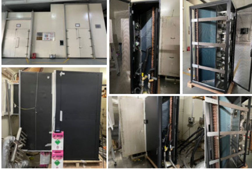
图3 空调末端实验实物图
