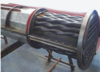
图 9 扭曲双壳式换热器壳体结构
