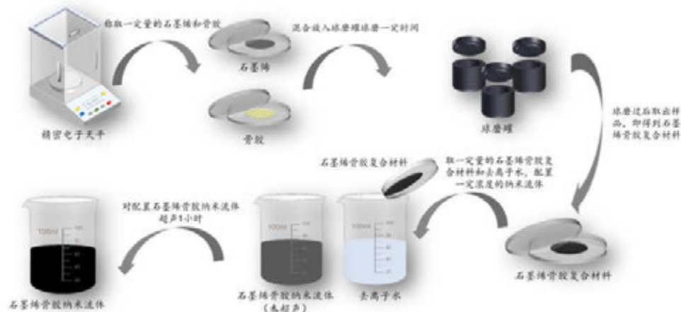
图 1 石墨烯骨胶纳米流体的制备流程
