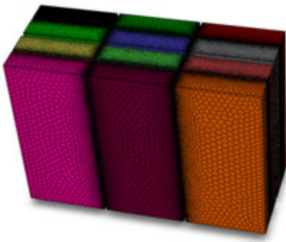
图 2 电池组网络模型
