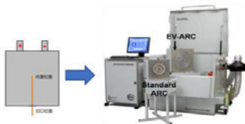
图 2 ES-ARC 测试示意图 [14]
